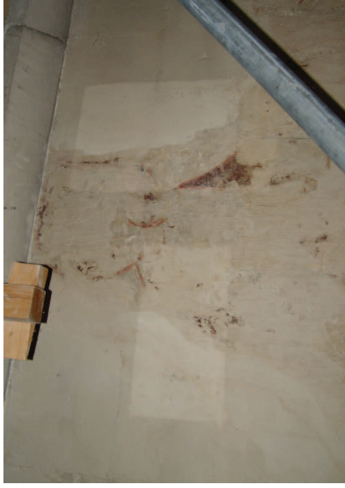
De uitgevoerde reinigingsfesten.
